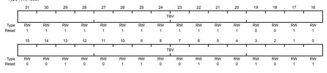
Bit/Field Name Type Reset Description 31:0 TBV RW 0x0000.FFFF GPTM Timer B Value
