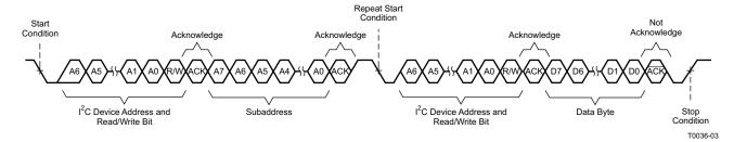
Figure 25. Single-Byte Read Transfer
