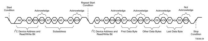
Figure 26. Multiple-Byte Read Transfer
